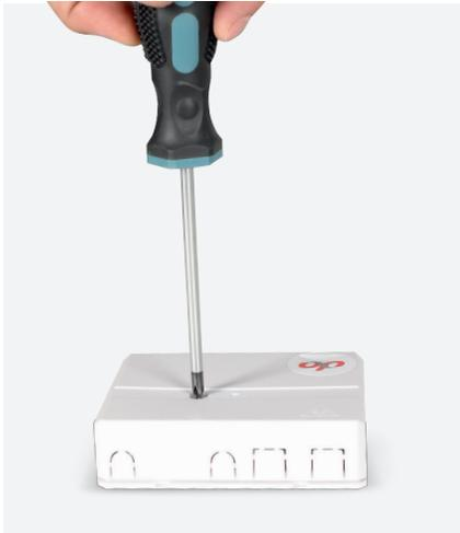
**PASO 1.** Con la ayuda de un **desarmador de punta de cruz** retire el tornillo de la cubierta.
